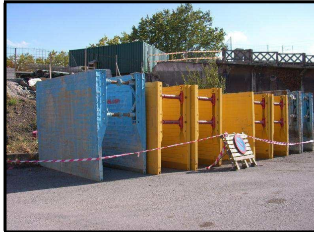
Paneles de entibación
